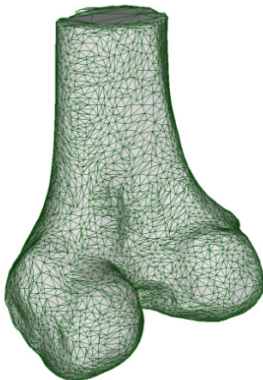
Obrázek B-4-1: Vstupní trojúhelníková síť reprezentující model části kolenního kloubu.
