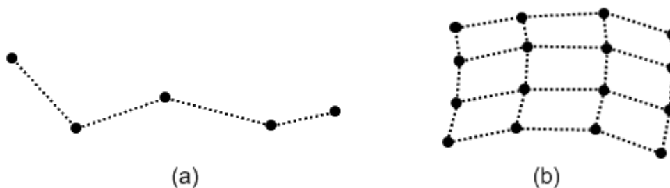
Obrázek 2-17: (a) vektor řídicích bodů 2D spline křivky, (b) obdélníková mřížka řídicích bodů 3D spline plochy.
