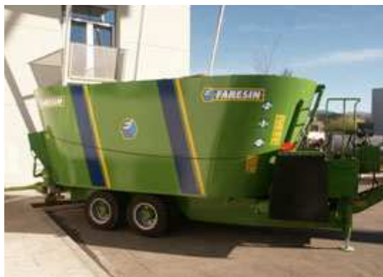
Obr. 3. míchací krmný vůz s oboustranným zakládáním krmiva
