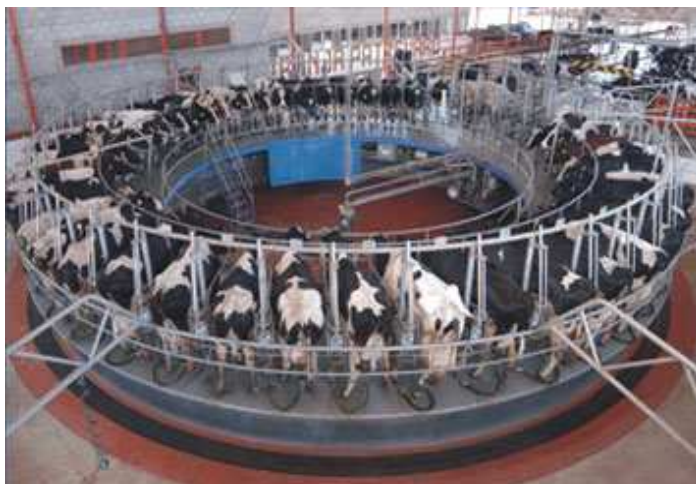
Obr. 16. Kruhová dojírna s paralelním uspořádáním stání
