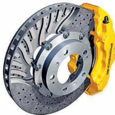
Obr. 4.2 Keramické brzdy montované do vozů Porsche [13]
