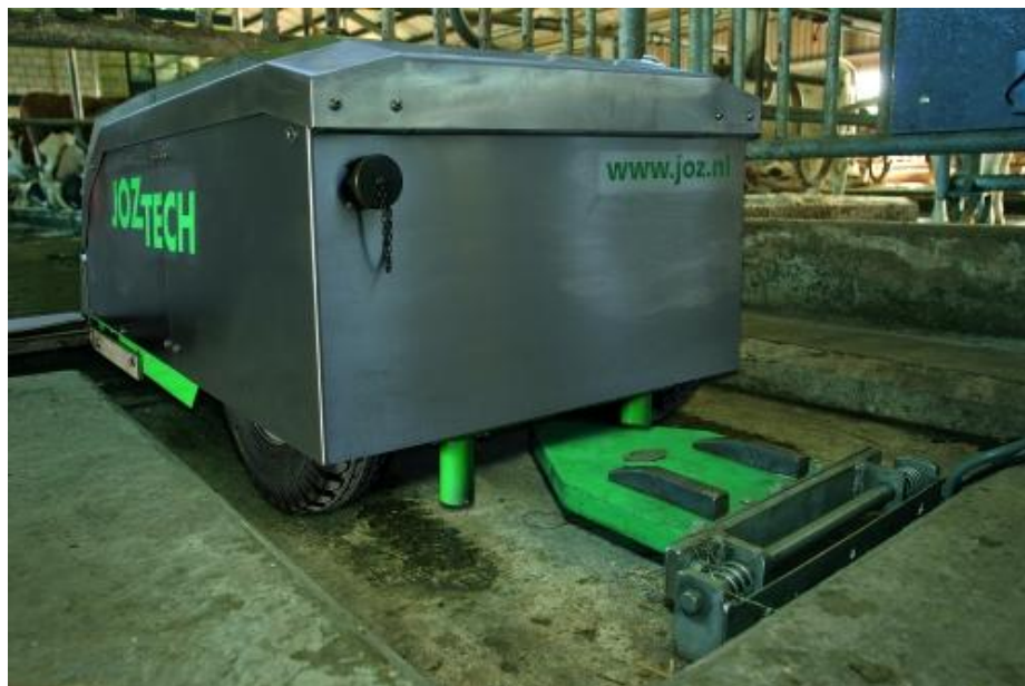
Obr. 23 JOZ - TECH Standart a napájecí stanice
