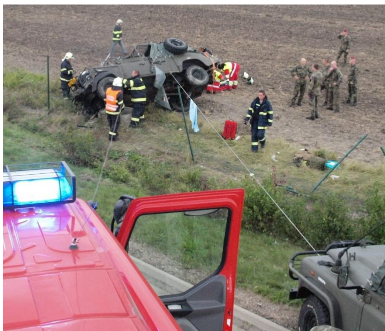
Obrázek č. 4 – stabilizace navijákem – archiv autora
