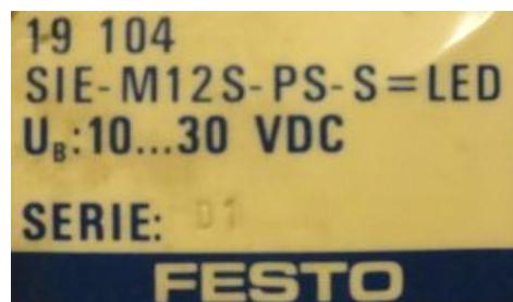
Obr.29 Obě strany typové štítku indukčního snímače
