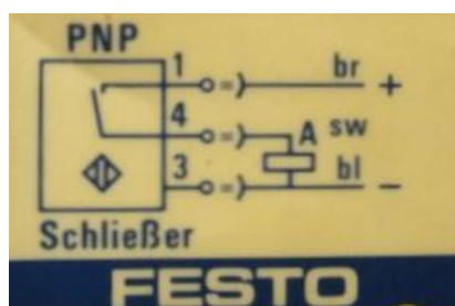
Obr.29 Obě strany typové štítku indukčního snímače
