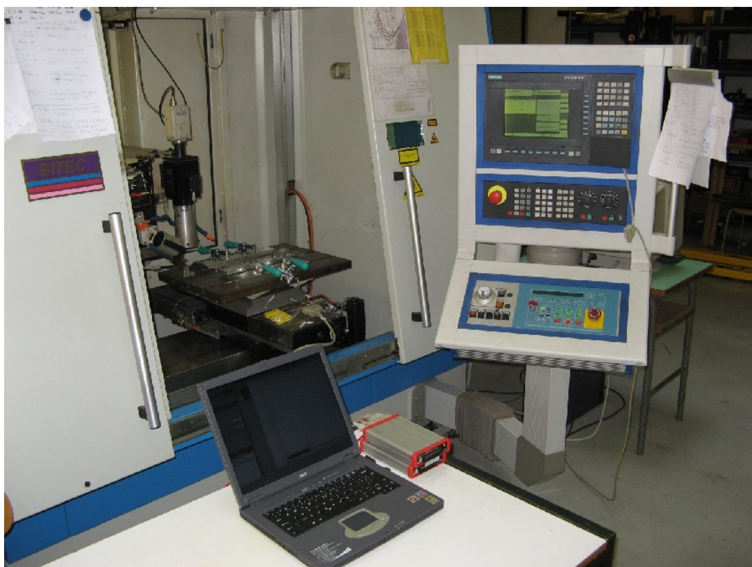
Obr. 4.15 Pulzní Nd:YAG laser s upínacím přípravkem a měřicí ústřednou
