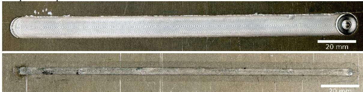
Obr. 4.17 Vzhled svarového spoje (vrchní a spodní část svaru) zhotoveného metodou Friction Stir Welding, AZ31 (1,6 mm, svar kolmo na podélný směr)
