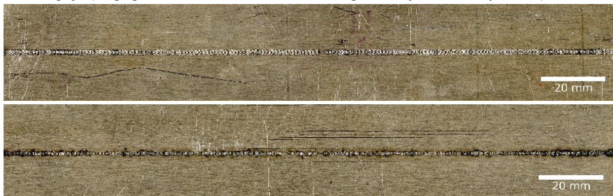
Obr. 4.30 Vzhled svarového spoje (vrchní a spodní část svaru) zhotoveného pevnolátkovým laserem, AZ31 (tl. 1,6 mm – svar kolmo na příčný směr)
