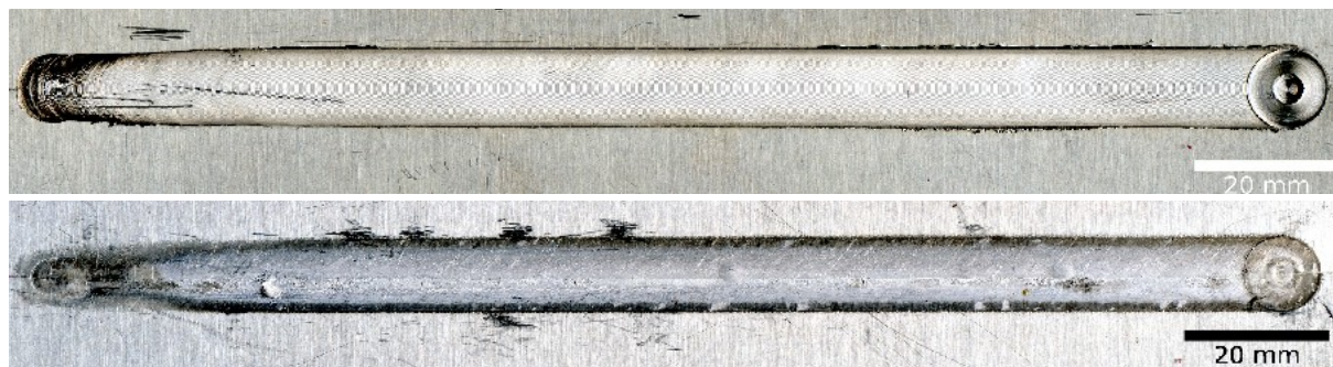
Obr. 4.18 Vzhled svarového spoje (vrchní a spodní část svaru) zhotoveného metodou Friction Stir Welding, AZ61 (0,8 mm, svar kolmo na podélný směr)
