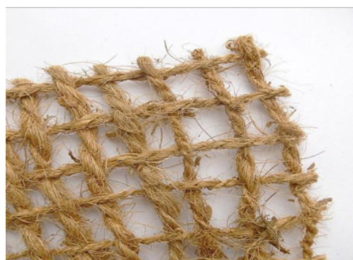
Obr. 10: Kokosová geotextilie (Geomat, 2017)
