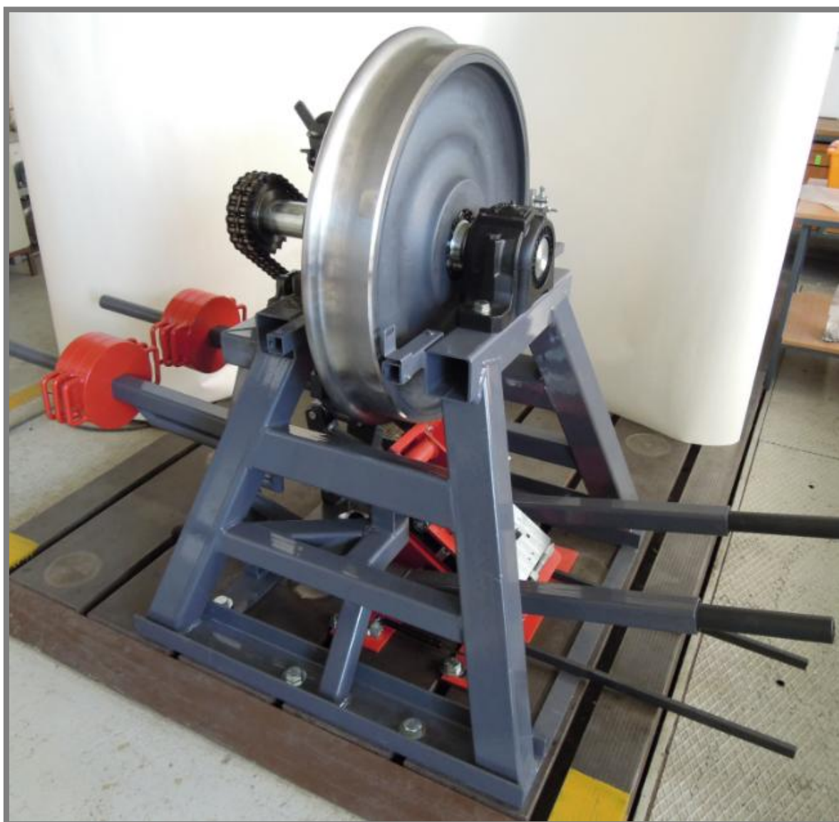
Obr. P19 Fotografie experimentálního zařízení – mechanismus k zprostředkování kontaktu
