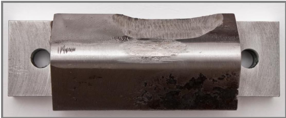
Obr. P22 Opotřebení vzorku kolejnice – čelní pohled
