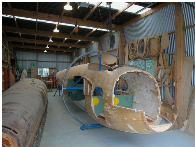
Obrázek 10: Pohled na dřevěný trup de Havilland DH.98 Mosquito při restauraci [77]
