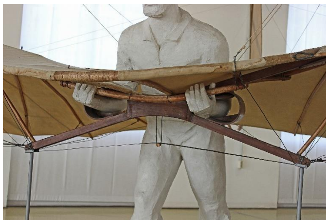
Obrázek 7: Detailní pohled na centrální část Lilienthal Normalsegelapparat [74]
