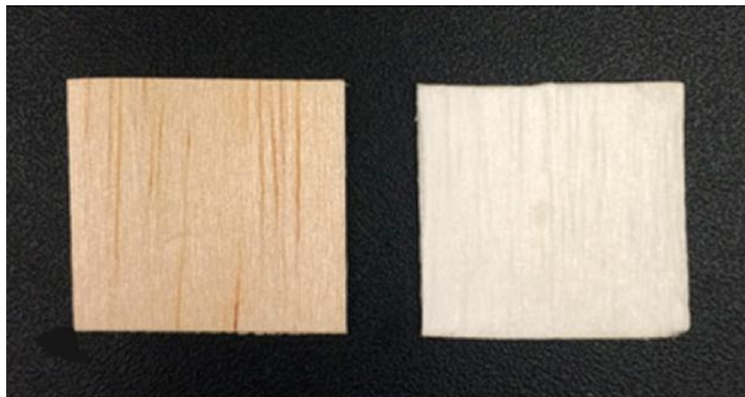
Obrázek 13: Dřevo před a po delignifikaci (upraveno z [59])
