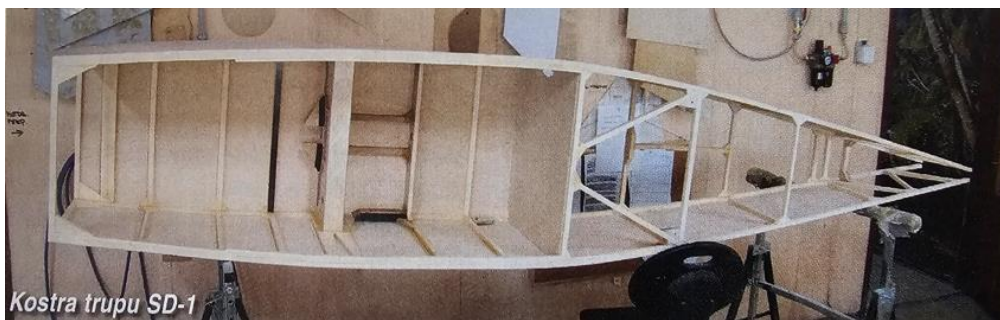
Obrázek 11: Pohled na dřevěnou kostru trupu letounu SD-1 [27]
