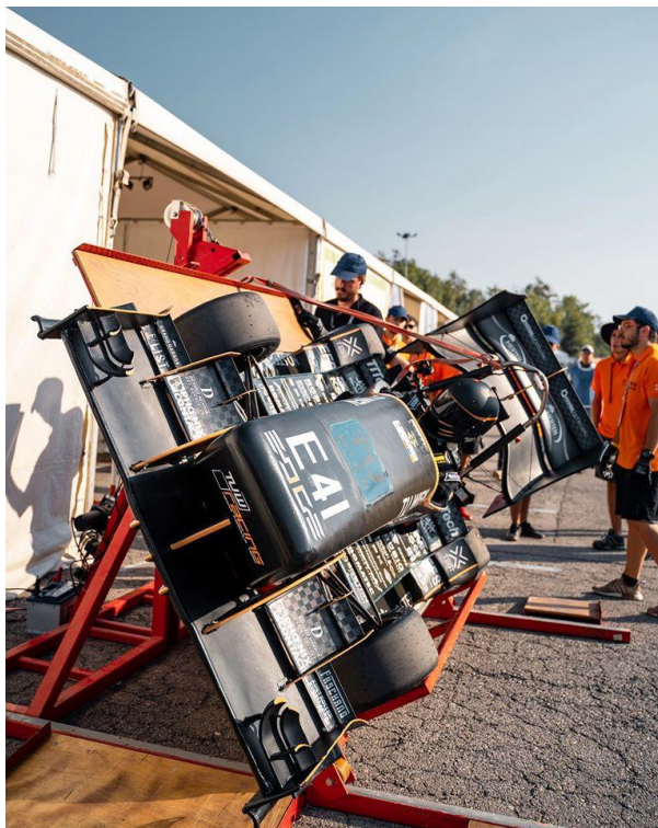
Obr. 3.9 - Záber na predné krídlo TUW Racing, s jasne viditeľnými elementami generujúcich vírenie na koncoch krídla
