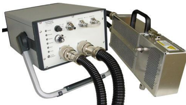
Obrázek 20: Vyobrazení ředícího zařízení spolu s řídicí jednotkou
