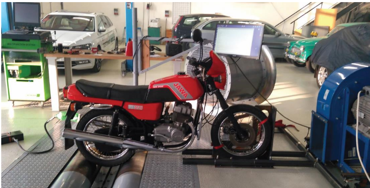
Obrázek 21: Instalace motocyklu na válcové zkušebně
