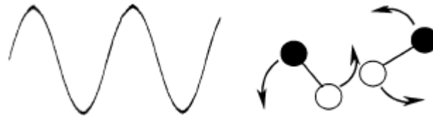
Obr. 8: Dipolární molekuly přizpůsobující se elektrickému poli
