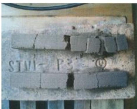
Obr. 18: Stav trámečků po ohřevu na 400 °C [18]
