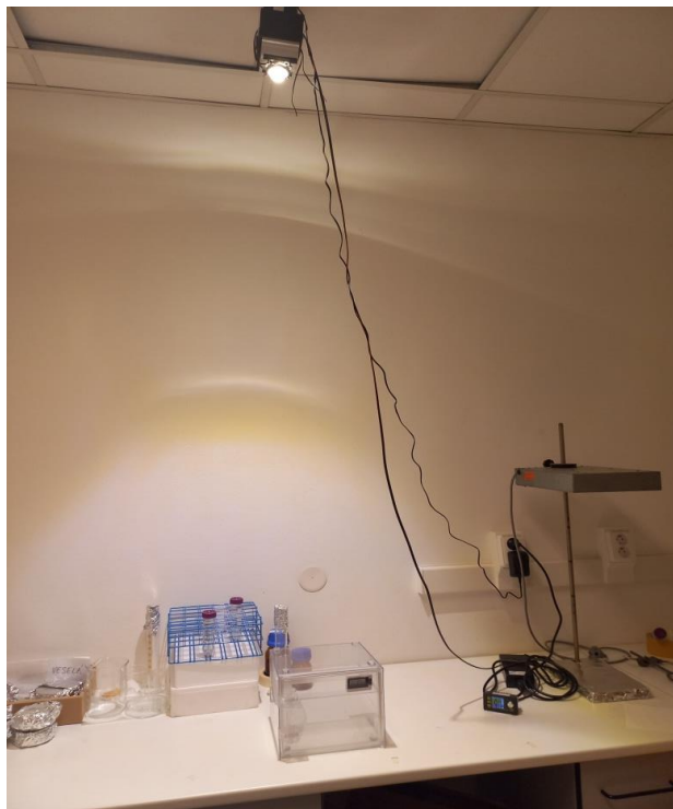
Obrázek 11: Aparatura pro osvětlování fólií v testovací komoře
