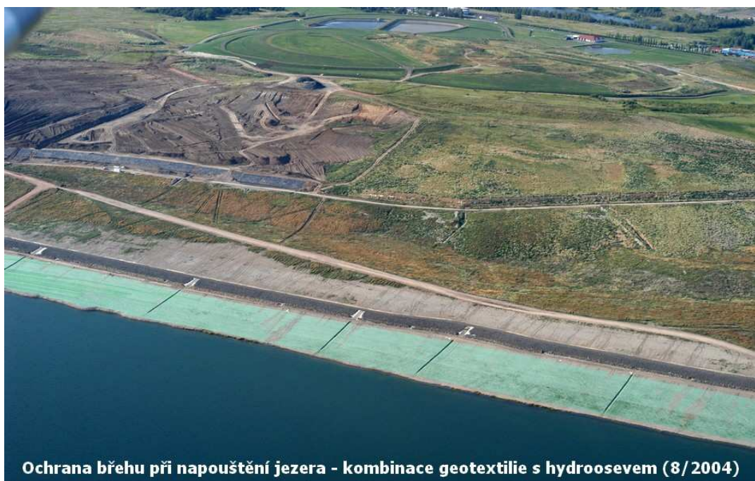
Obr. 7 Kombinace geotextilie s hydrosevem
