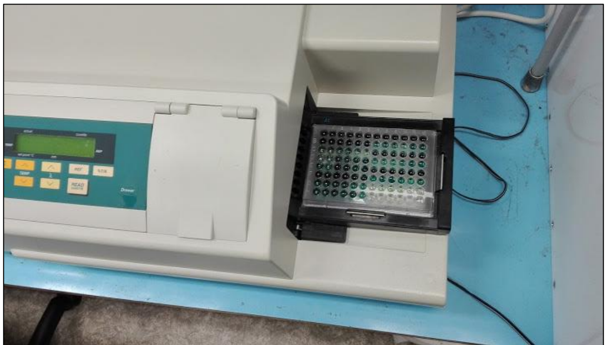
Príloha 18 - Samotné stanovenie enzymatickej aktivity na spektrofotometri s 96 kvetami
