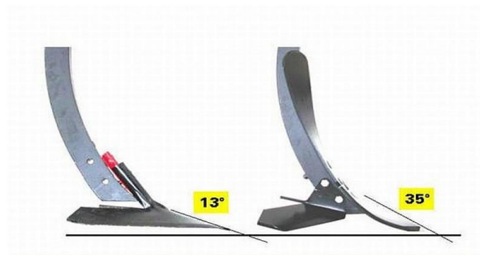
Obrázek 15 Princip uchycení radliček ClipOn a MulchMix
