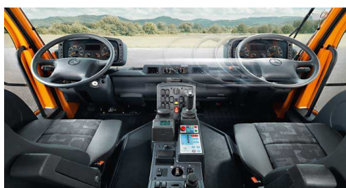
Obr. 29 Mulag U400 – přestavitelné řízení VarioPilot
