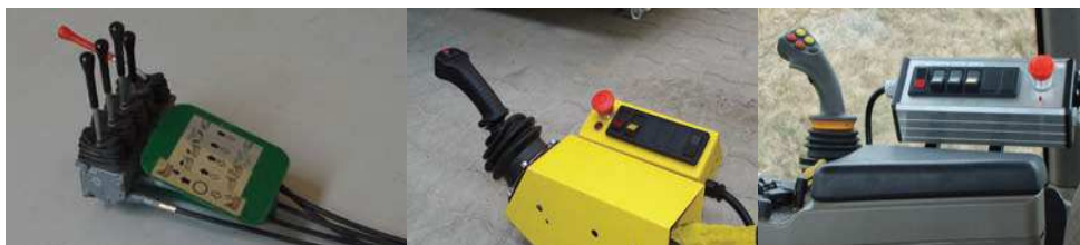
Obr.34 Pákové ovládání s lanovody, joystickem, hydraulicky proporcionální ovládání, joystickem, elektricky proporcionální
