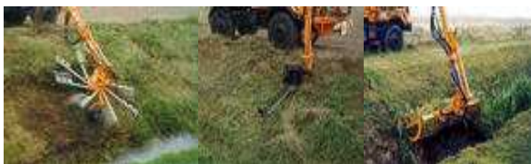
Obr. 7 Mulag FME 600 - údržba příkopů
