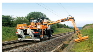
Obr. 9 Mulag ME 700 – DB - při sečení po stranách trati
