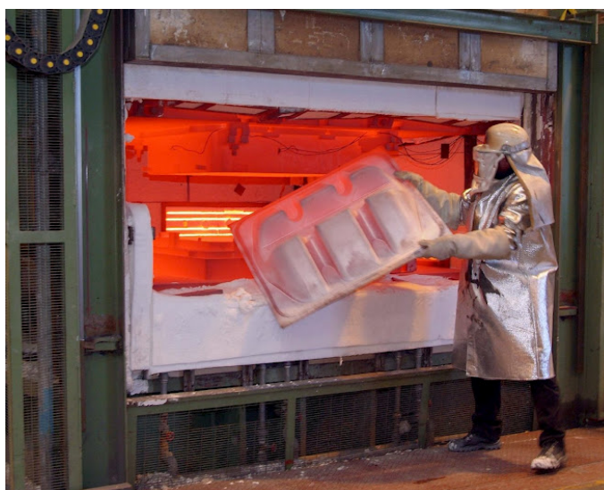
Obr. 2.3: Ukázka manipulace s vyhotoveným titanovým dílcem ve firmě Aeromet International, teplota 910°C, 5000 N zatížení [9]
