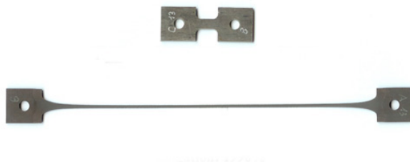
Obr. 1.1: Vzorek před a po superplastické deformaci [7]
