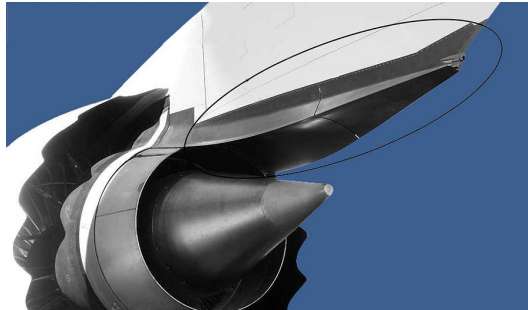
Obr. 2.9: Tepelný štít vyrobený z Ti slitiny pro ochranu částí okolo proudových motorů letadel [12]
