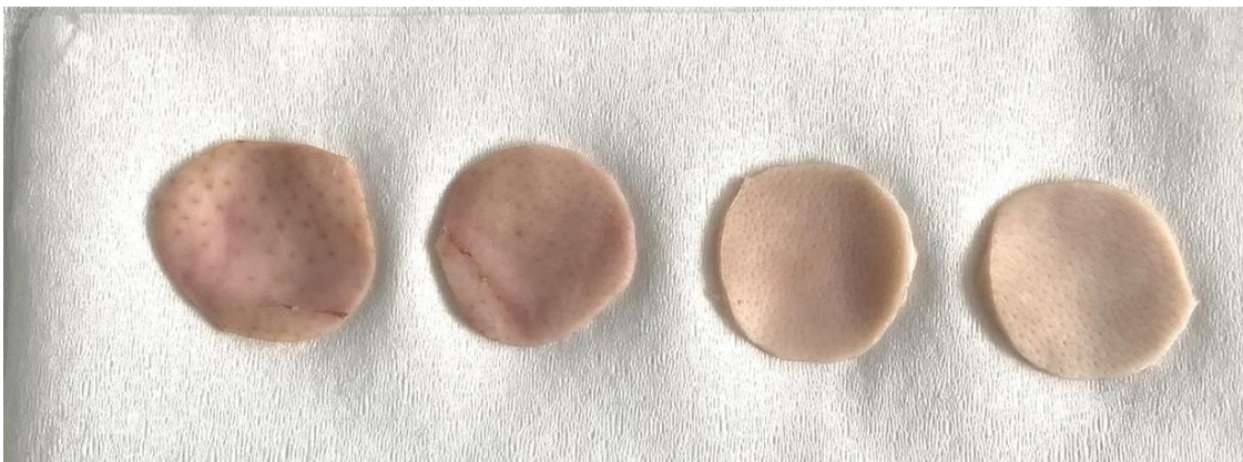
Obrázek 8 Prasečí membrány pro simulaci penetrace aktivních látek
