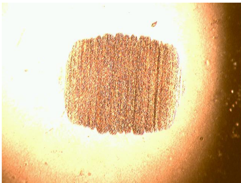
Opotřebovaná ocelová kulička při HFFR testu běžného oleje 10x zvětšeno
