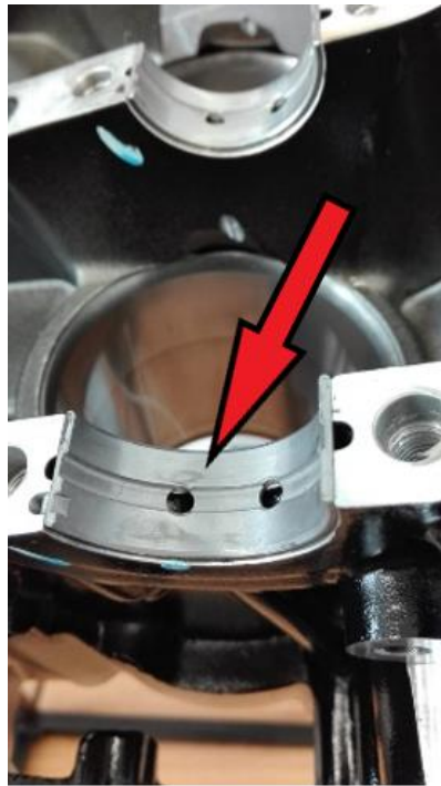
Obrázek 2.10.2 Poškozená kluzná ložiska klikového hřídele u motoru Triumph Daytona 675
