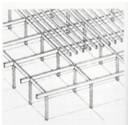
Obr. 3 : Jednoduchý stĺp a nosník, koštrukcia jednopodlažná (Havířová Z.,2006)
