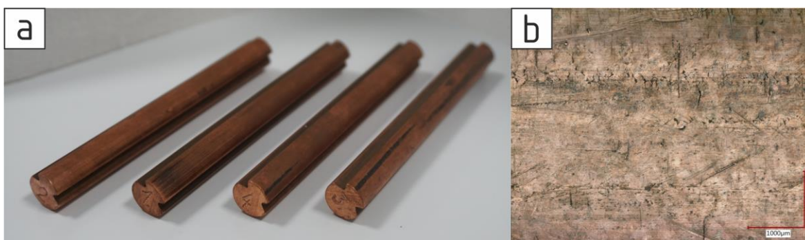
obr. 4-3 a) vzorky trolejového drátu, b) snímek povrchu troleje digitálního mikroskopu Keyence VHX-6000
