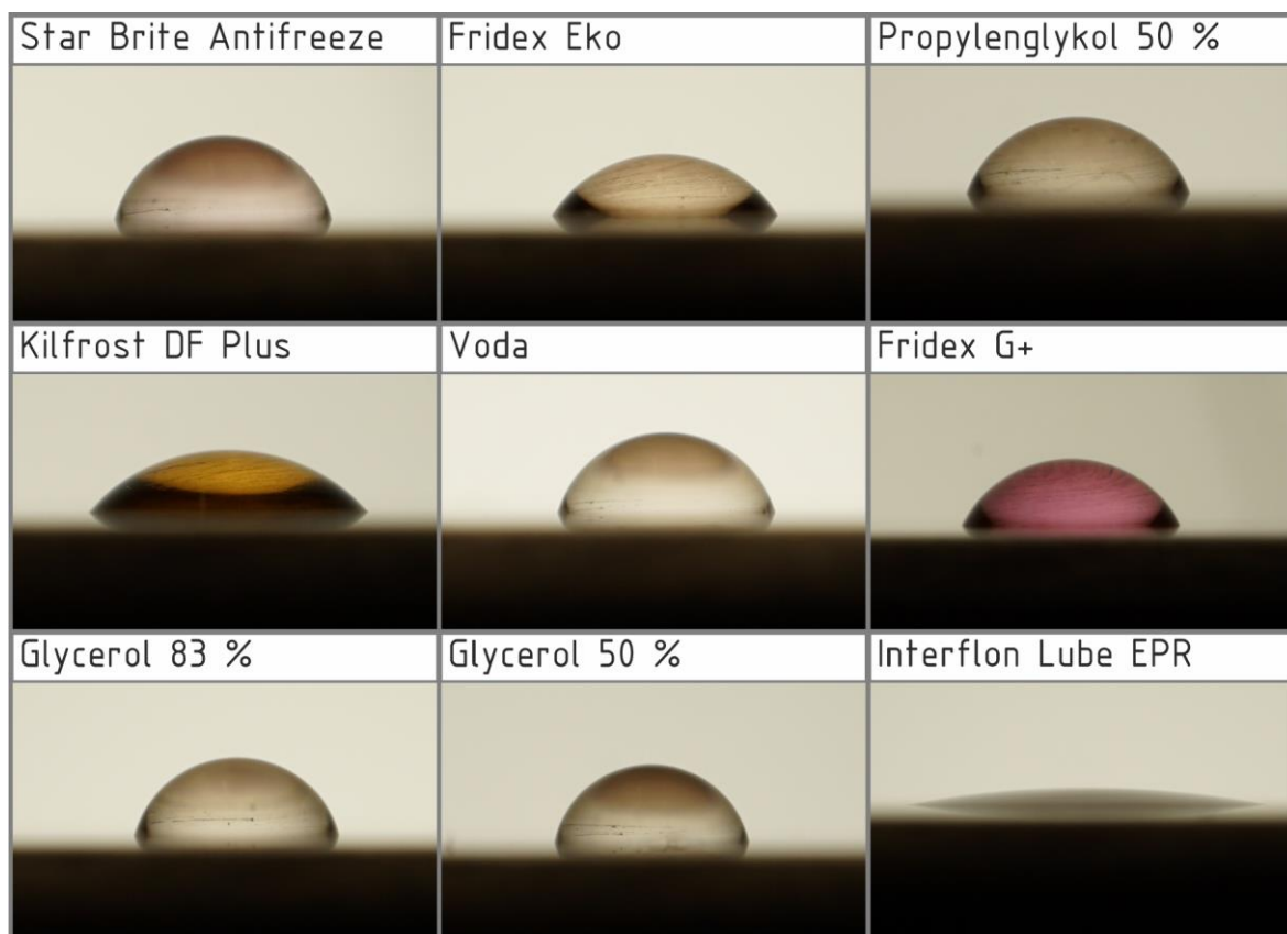
obr. 1 Fotografie kapky směsí proti námraze o velikosti 2 \mu l na měděném povrchu
