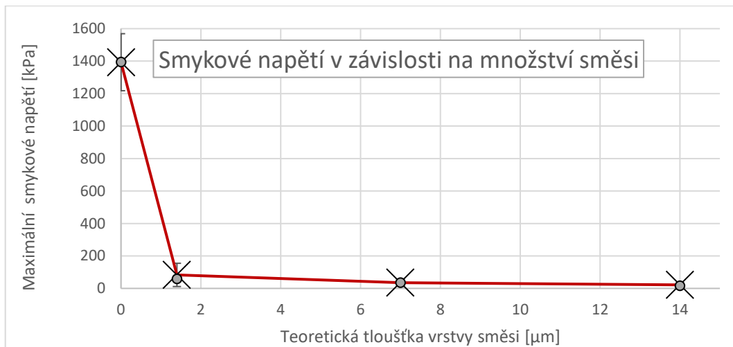
obr. 6-1 Velikost adheze v závislosti na teoretické tloušťce vrstvy směsi
