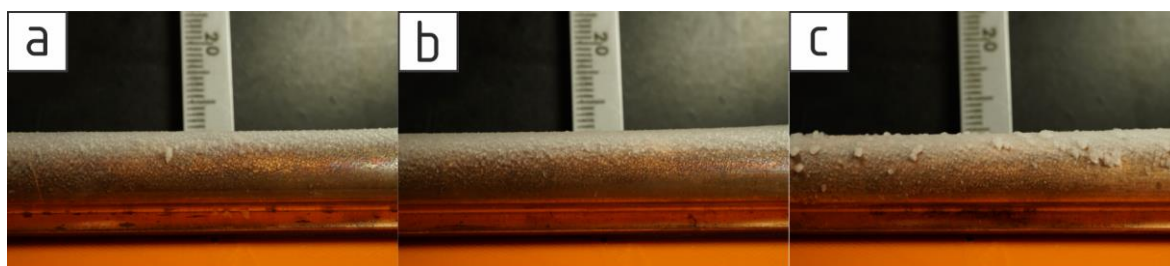
obr. 5-18 Námraza vzniklá na povrchu vzorku trolejového drátu po 2 min růstu v rámci 3. námrazového cyklu, a) vzorek bez protinámrazové směsi, b) Kilfrost DF Plus, c) Inteflon
