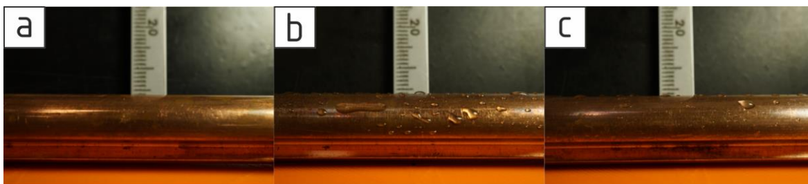
obr. 5-11 Forma nánosu směsi na povrchu trolejovém drátu, a) Interflon Lube EPR, b) Glycerol 83 %, c) Propylenglykol 50 %
