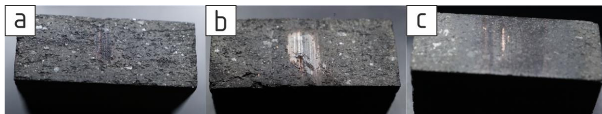
obr. 5-20 Pohled na opotřebovanou plochu uhlíku po testech za použití různých směsí, a) Glycerol 83 %, b) Propylenglykol 50 %, c) Interflon Lube EPR
