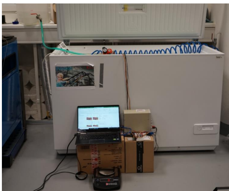
obr. 5-15 Měřicí sestava, na které probíhali experimenty s kinematikou námrazy
