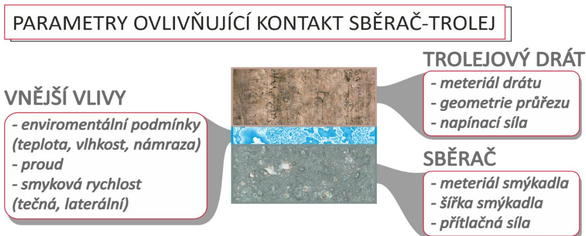
obr. 3-1 Otevřený tribologický systém popisující kontakt sběrač-trolej
