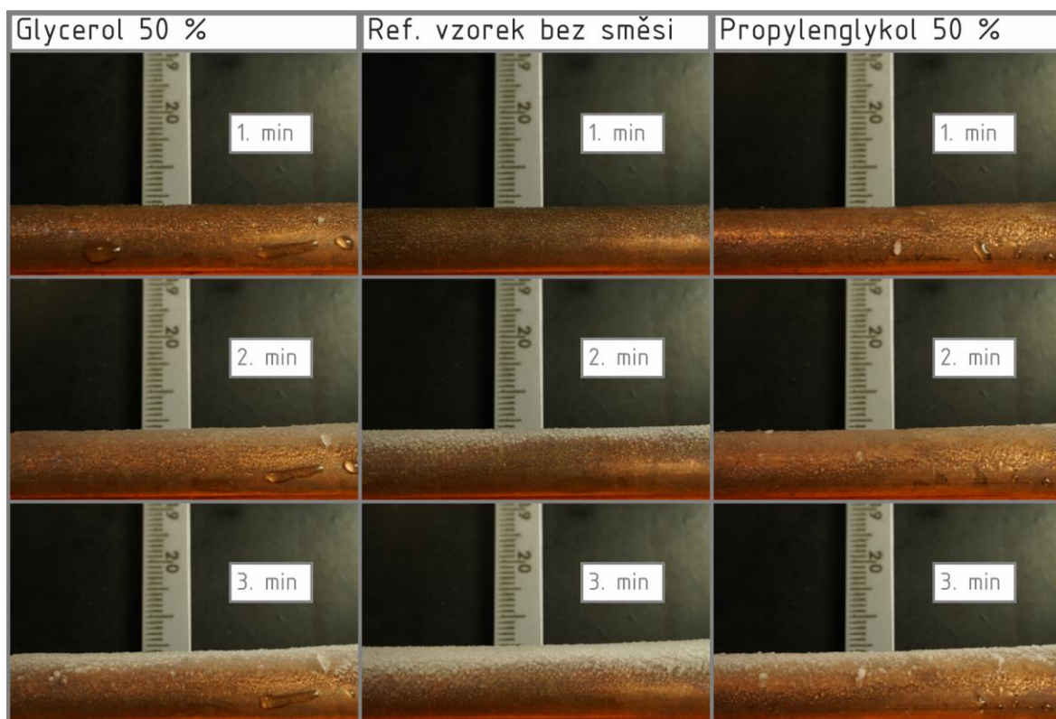
obr. 4 Měření kinematiky námrazy 4. sada vzorků – při měření došlo k většímu ochlazení přiváděné vody a první v první minutě došlo k růstu průsvitné námrazy
