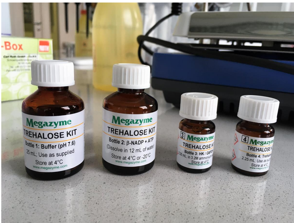
Obrázek 29 - Lahvičky s obsahem jednotlivých kitů: lahvička 1 - buffer, lahvička 2 - NADP + ATP, lahvička 3 - HK/G6PDH, lahvička 4 – trehaláza, zdroj: (Anna Krejzková)
