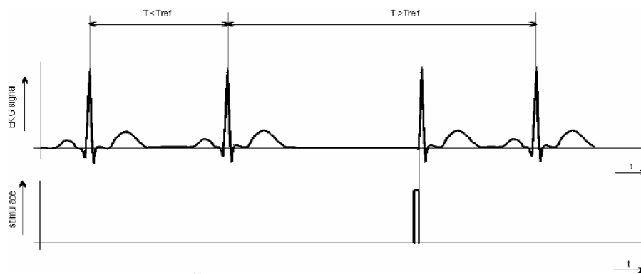
Obrázek 8. Časové průběhy kardiostimulátoru s režimem on demand.
