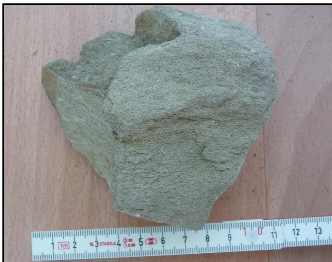
Obr. 7 Droba odebraná z obvodové zdi (obr. 5, dokumentační bod 15)
