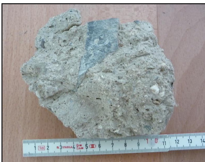
Obr. 12 Malta odebraná ze zříceného klenebního oblouku (obr. 5, dokumentační bod 17)
