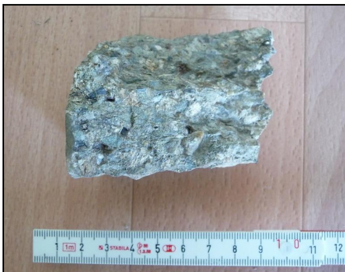
Obr. 8 Slepenec odebraný z obvodové zdi (obr. 5, dokumentační bod 14)
