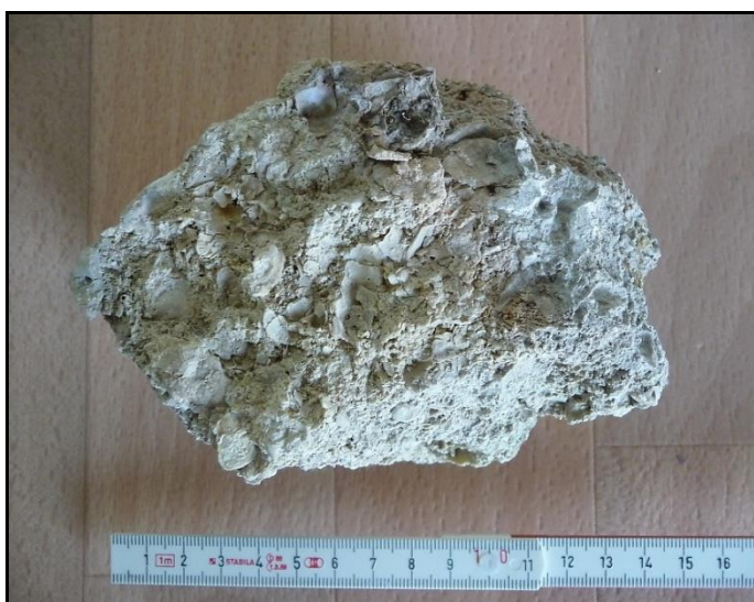
Obr. 10 Lumachela, odebraná z římsy (obr. 5, dokumentační bod 12)
