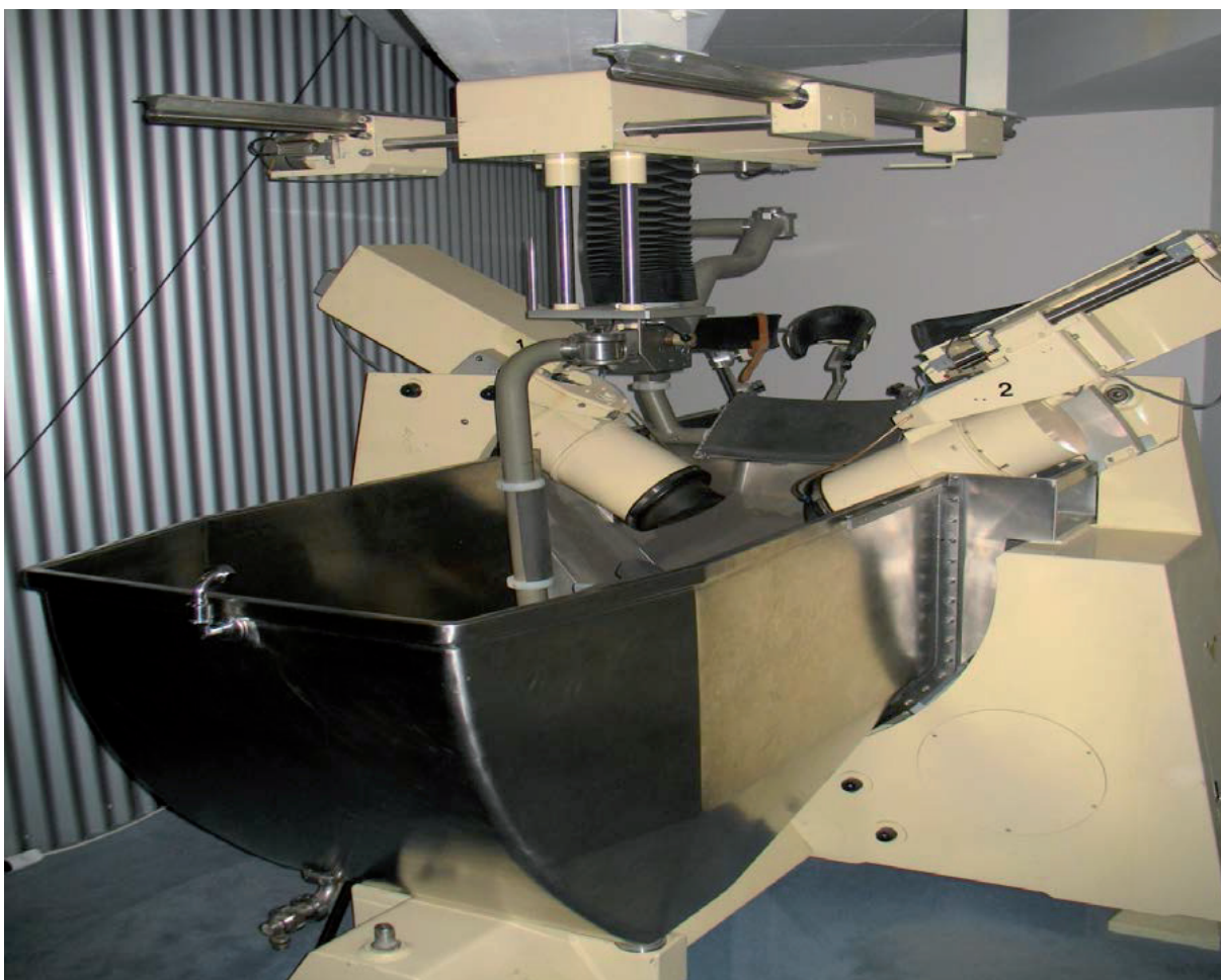
Obr. 9: Prvý litotriptyor – Dornier HM1 – klinicky uvedený do praxe v r. 1980 na Univerzitnej klinike Großhadern v Mníchove – SRN, typický pre prvogeneračné litotriptyory je tzv. „wet“ coupling
