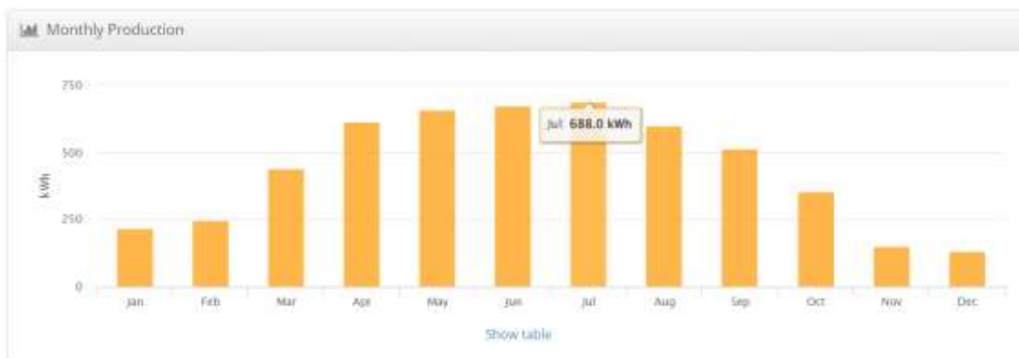
Obr. 5: Graf výkonu fotovoltaických panelů [ https://app.helioscope.com/ ]
