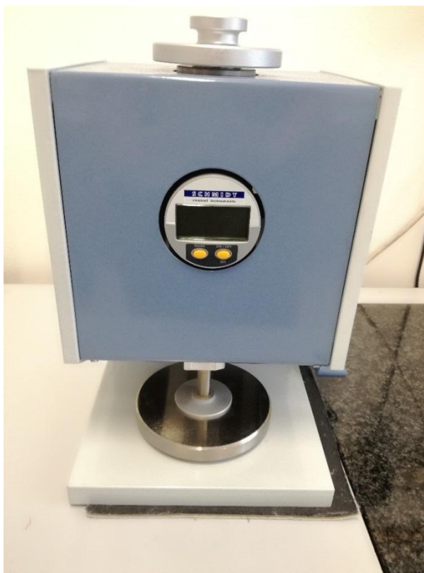
Obrázek 1: Mesdan LAB - Příklad pro měření tloušťky tkanin
