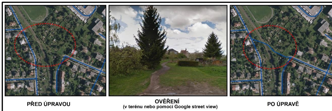
Obr. 2: Vytvoření chybějící reálné spojnice v modelu dopravní sítě na příkladu ulic Na Trati a Kašparova Zdroj: CDV (2017a), ČÚZK (2018), Google Street View (2015); vlastní zpracování
