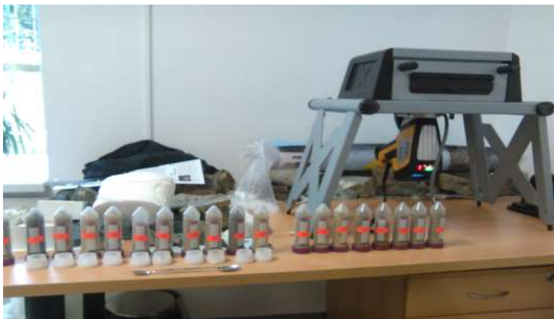
Obr. 11 Laboratorní měření vzorků půd pomocí RFA analyzátoru (foto autor).
