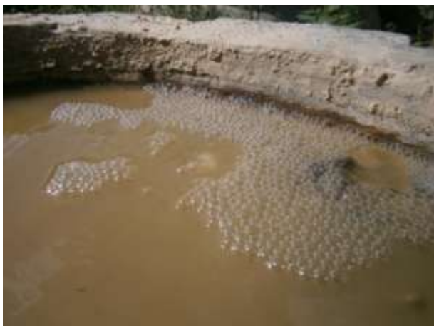
Obr4: úniky CH 4 z poškozeného hlavního tanku
