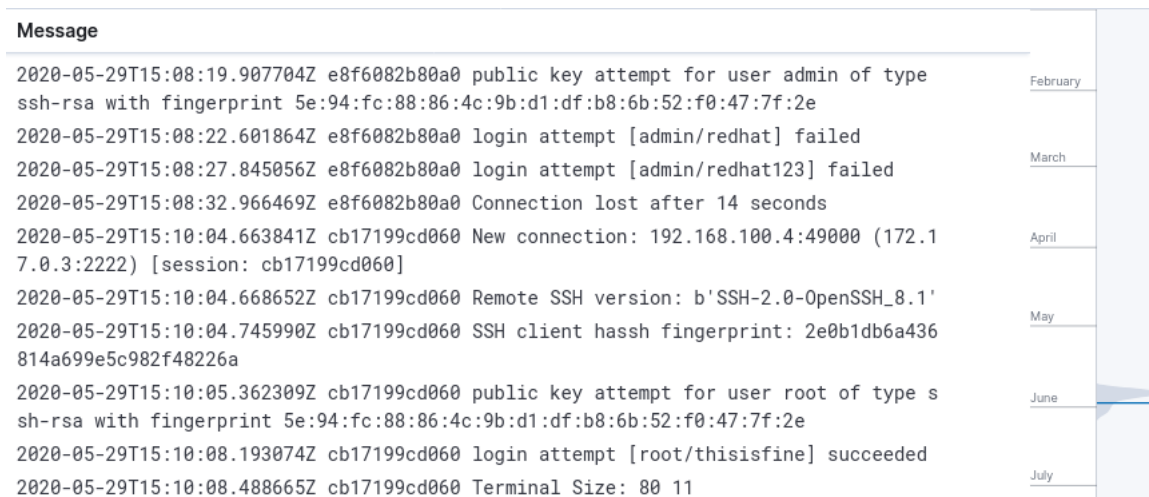
Obr. 6.3: Záznamy z Cowrie na centrálním log a NetFlow serveru
