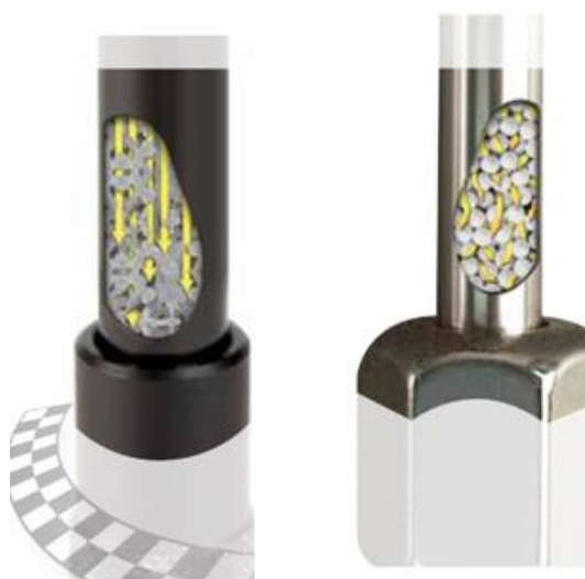
Obrázok 2.16 Porovnanie náplne monolitickej (vľavo) a časticovej (vpravo) kolóny 63
