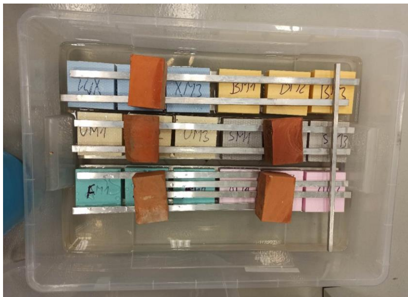
Obrázek 23 - Zkouška dlouhodobé nasákavosti při plném ponoření metodou 2B
