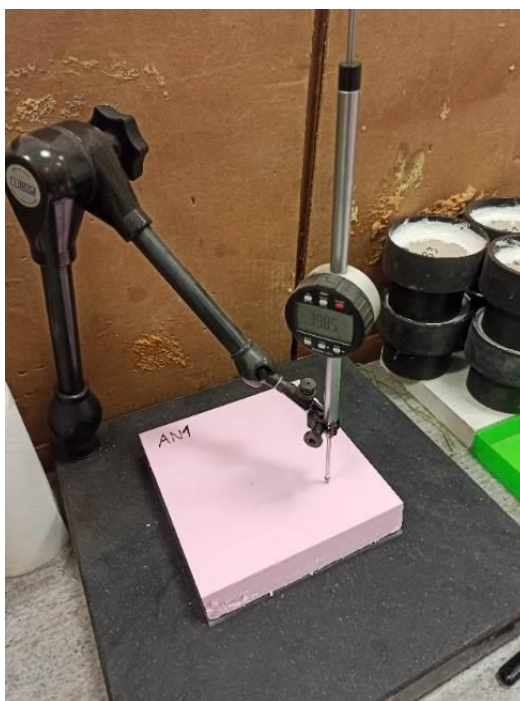
Obrázek 22 - Měření tloušťky úchylkoměrem
