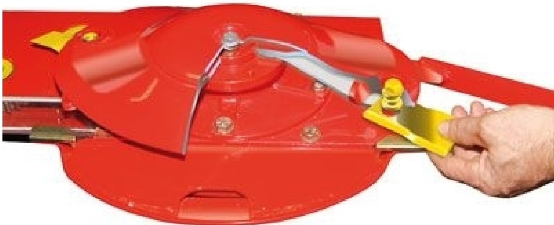
Obrázek 2.9: Detail otočného uložení nože
