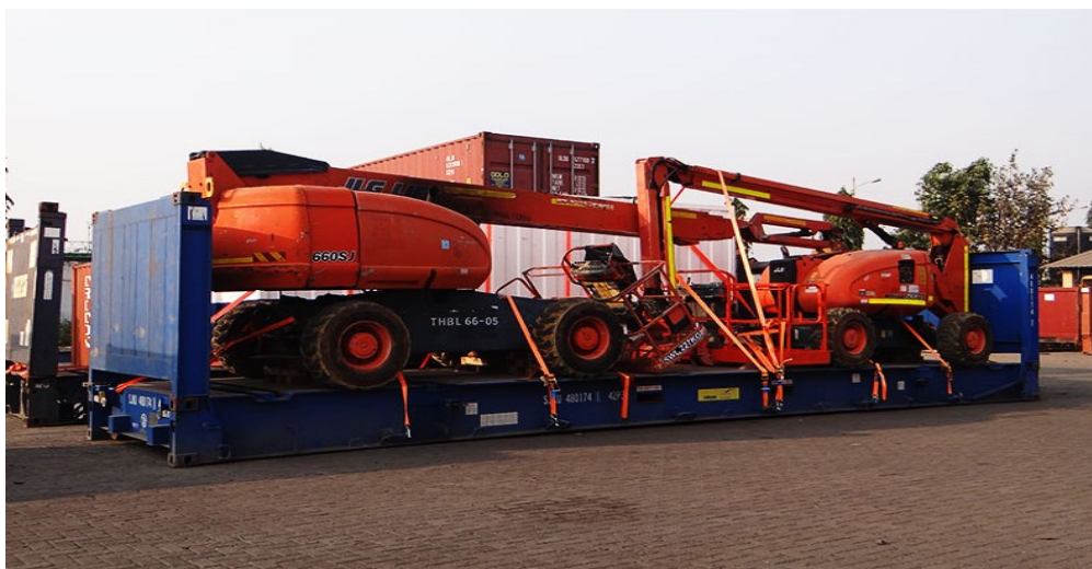
Obr. 1.6 Plochý 40“ Rack so sklopnými koncami Zdroj: [26].
