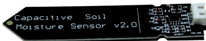
Obrázek 2.3 Kapacitní snímač vlhkosti půdy SEN0193
