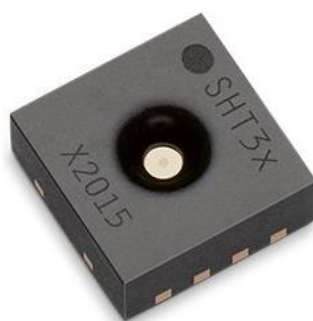
Obrázek 2.4 Sensor teploty a vlhkosti vzduchu SHT30[12]
