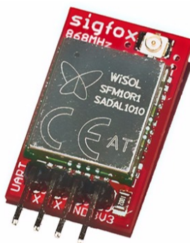
Obrázek 2.8 LPWAN SigFox Node UART Modem [18]
