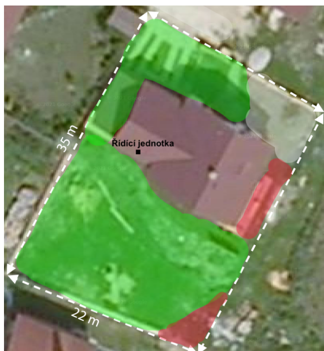
Obrázek 3.3 Testování dosahu komunikace nRF24L01
