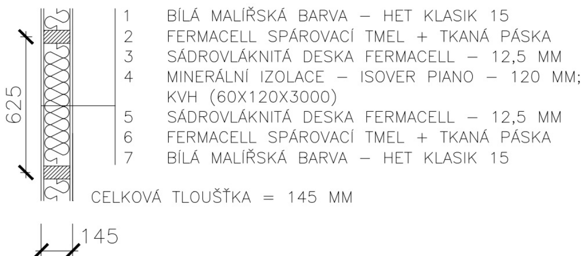
Obr. č. 10 - Skladba vnitřní nosné stěny
