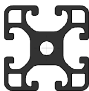
Obrázek 26 - Průřez hliníkovým profilem Haberkorn
