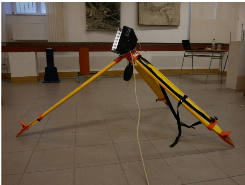
Obrázek 11: Halogenový reflektor umístěný na geodetickém stativu.
