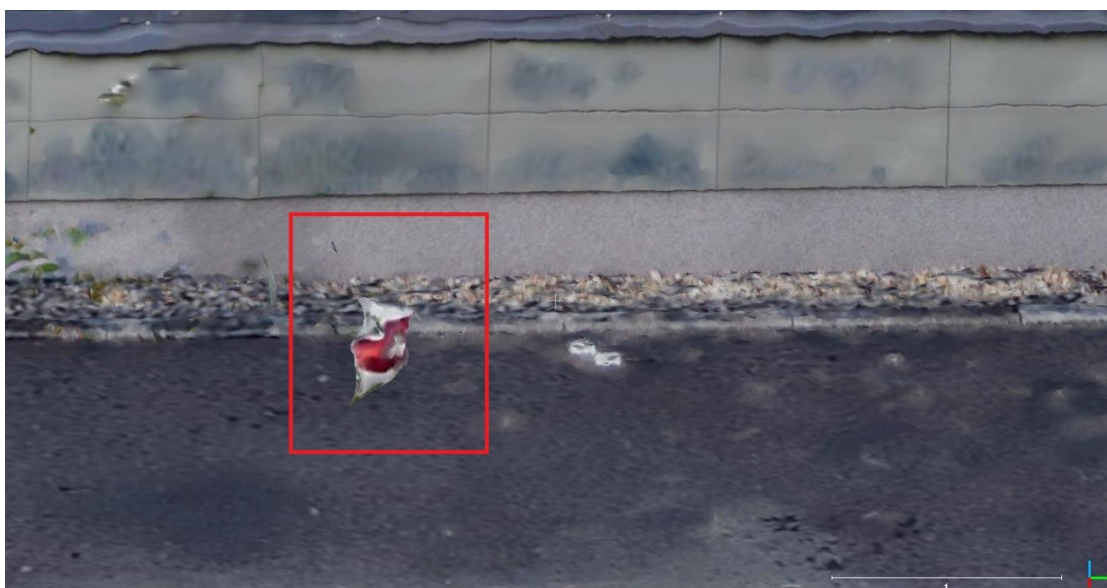
Obrázek 31: Identifikace části automobilu v programu Cloud Compare, který se nachází pouze na leteckých snímcích. Díky textuře 3D modelu je jednodušší identifikace těchto částí, které v netexturovaném modelu často splývají s okolím.
