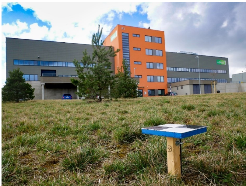
Obrázek 17: Fotogrammetrický terč umístěný na speciální konstrukci.
