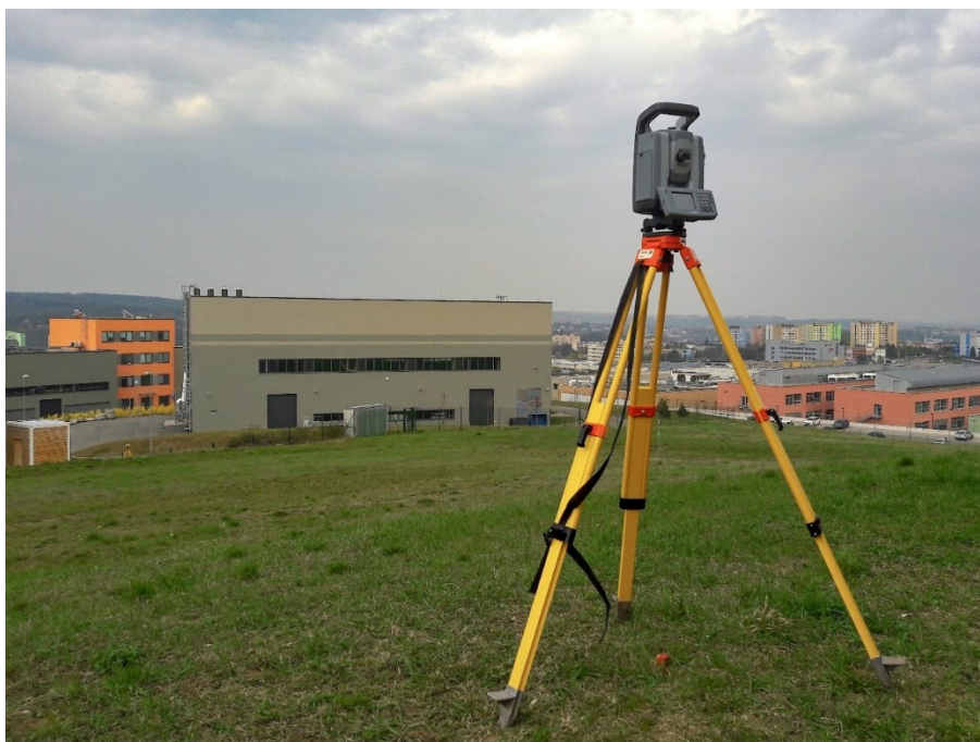
Obrázek 22: Přístroj Trimble S8 během měření nad areálem AdMaS.
