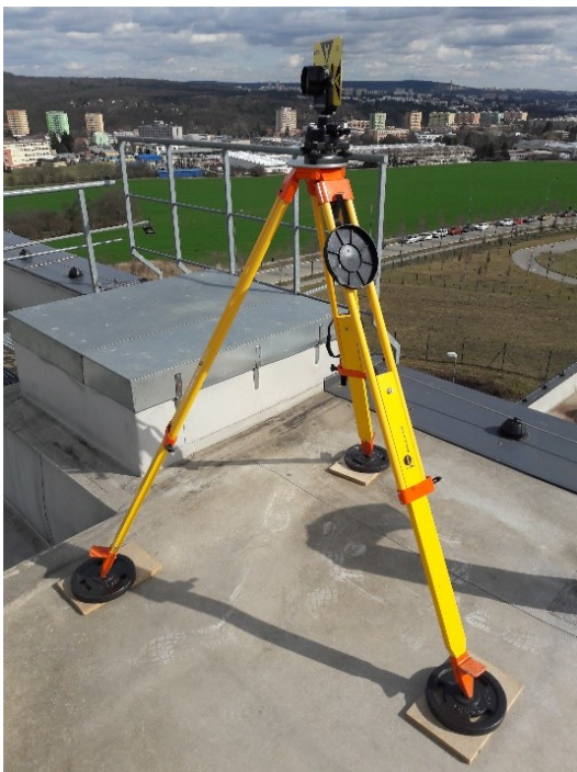
Obrázek 16: Ukázka zřízení měřického stanoviště na střeše budovy P1.
