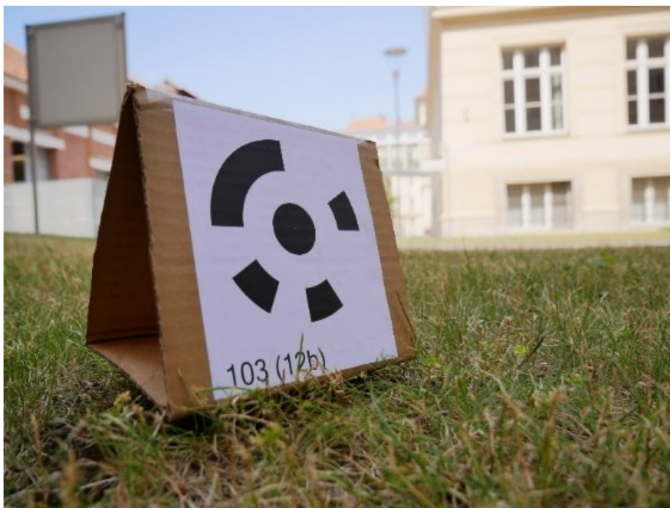
Obrázek 10: Ukázka kódového terče umístěného na kartonovém podstavci.
