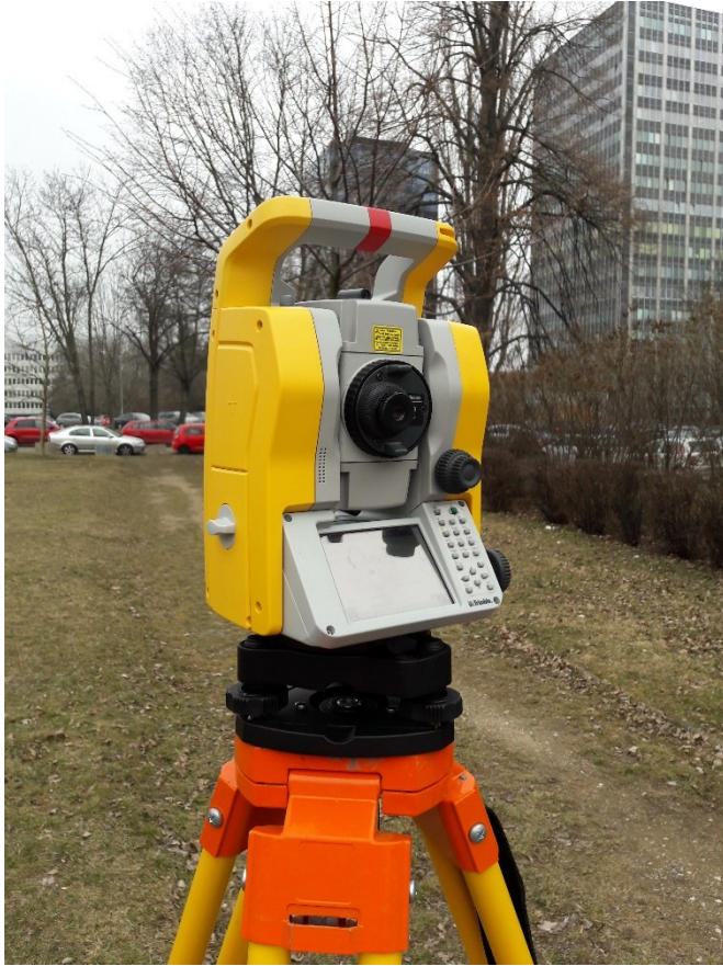
Obrázek 21: Totální stanice Trimble M3.
