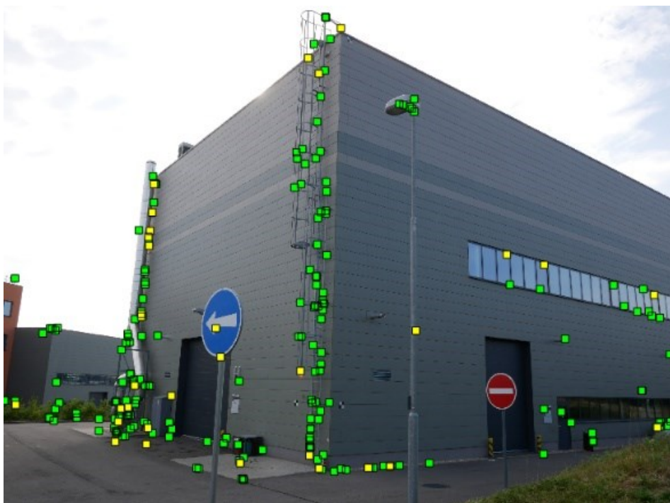
Obrázek 5: Automaticky vytvořené navazovací body. Kvalita bodu je rozlišena dle reprojekční chyby podle Tabulka 1.
