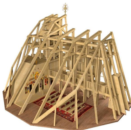
Obr. 21 Model skeletové konstrukce
