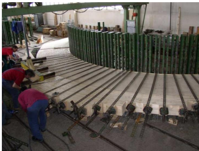
Obr. 1 Lepení zakřiveného rohu (ČDZ Praha, závod TESKO)
