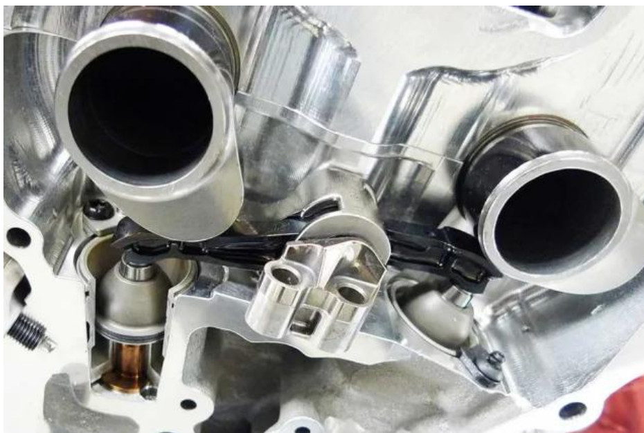
Obr. 2.17: Rozvod DOHC s vahadlem a pneumatickou pružinou [30]
