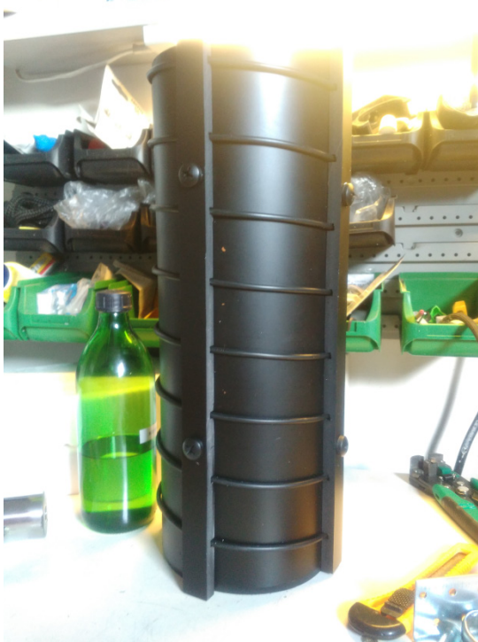
Fotografia 10 Osadenie držiakov drôtu na PVC rúru
