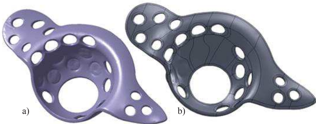
Obrázek 11.8: Model geometrie BS dlahy a) získaný ze skenování, b) s rozdělenými plochami respektující následnou diskretizaci
