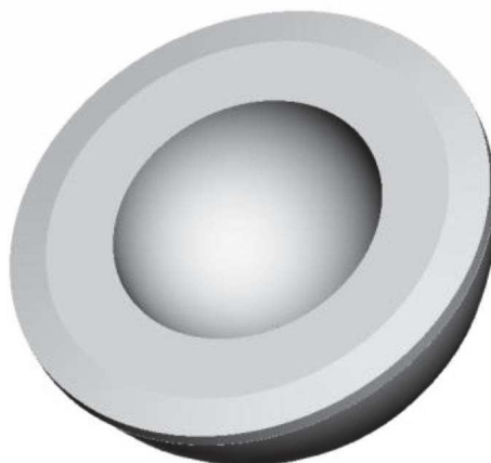
Obrázek 11.12: Model geometrie acetabulární vložky
