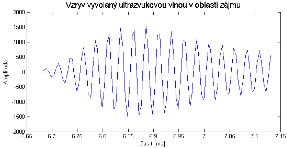
Obrázek 3.20: Signál v oblasti zájmu zachycující vzryv vyvolaný příjmem ultrazvukové vlny
