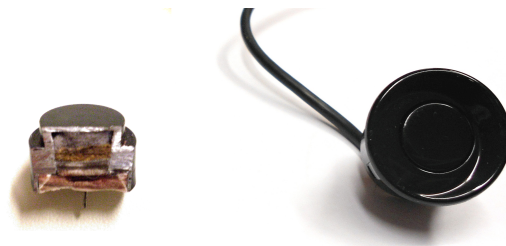
Obrázek 3.9: Využitý piezoelektrický akustický měnič pro vysílání a příjem ultrazvukových vln
