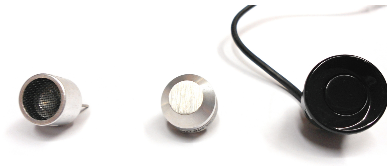
Obrázek 3.2: Piezoelektrické akustické měniče pro vysílání a příjem ultrazvukového signálu – vlevo otevřené provedení, uprostřed a vpravo uzavřené se zvýšeným krytím proti vlhkosti
