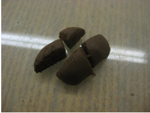
Příloha č. 14: Polovina vzorku pro stanovení meze plasticity. Je již rozdělena na čtyři díly pro dílčí zkoušky.
