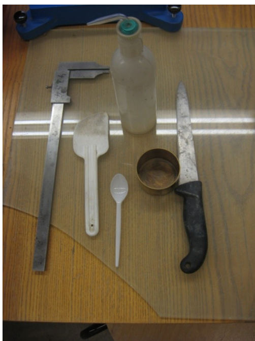
Příloha č. 9: Pomůcky. (zleva) posuvné měřidlo, stěrka, lžice, stříčka, míchací miska, nůž na míchací desce.
