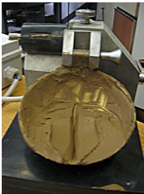
Příloha č. 13: Naplněná Casagrandeho miska
