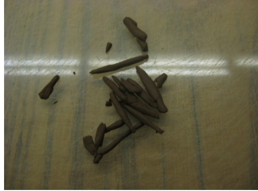
Příloha č. 15: Vyválené válečky z poloviny vzorku.
