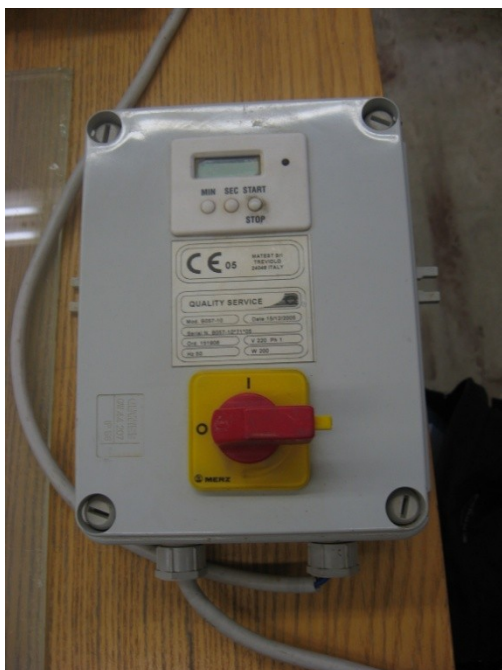
Příloha č. 7: Elektrické spouštěcí zařízení penetračního kužele
