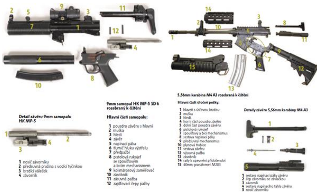
Obrázek 2 – rozebraný samopal MP-5 a útočná puška
