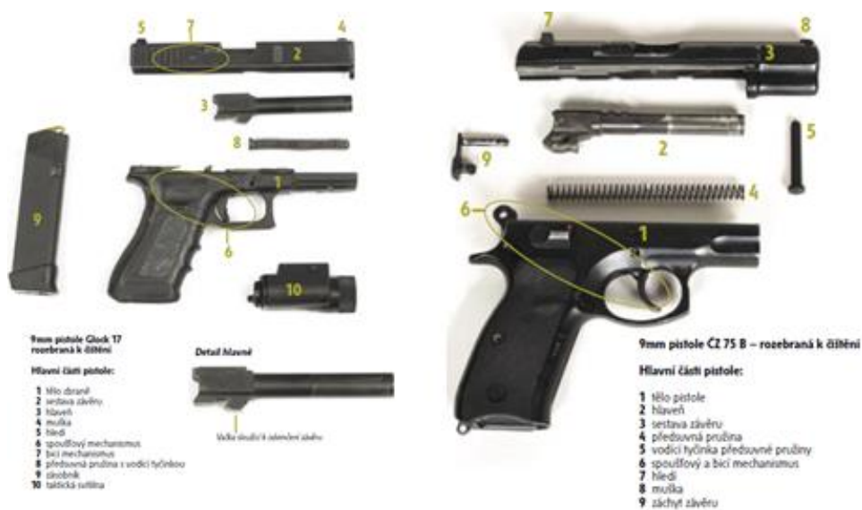
Obrázek 1- rozebrané pistole GLOCK 17 a ČZ 75B
