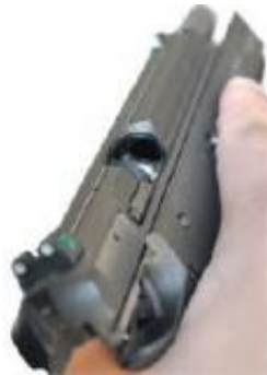
Obrázek 8 - kontrola nábojové komory
