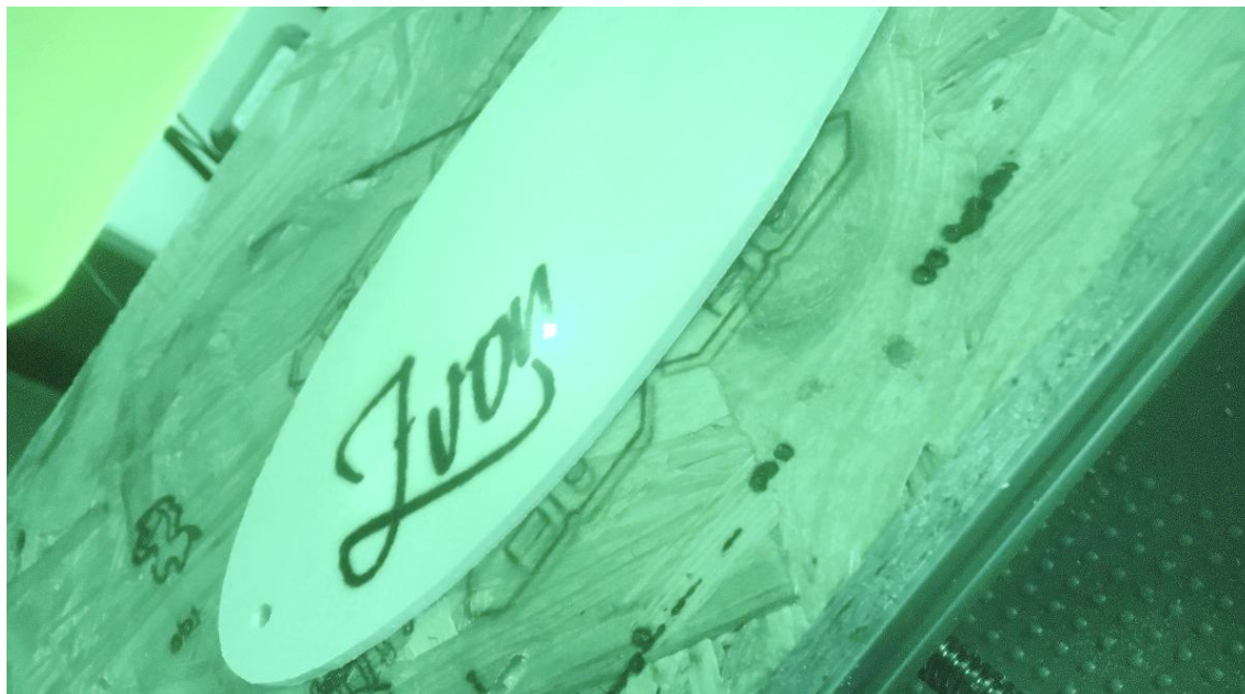
Obrázek 15 - Gravírování textu na jmenovku
