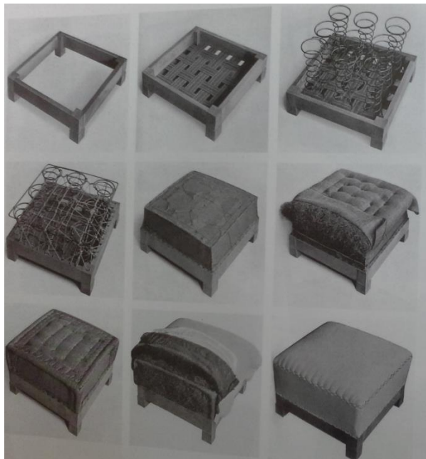
Obrázek 33: Ukázka výroby pevného čalounění (H. Prokopová, V. Štokr, Brno 2006)
